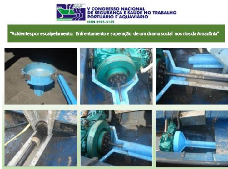
Figura 28 – Proteção do eixo cardã desenvolvido em fibra de vidro pela Fundacentro
