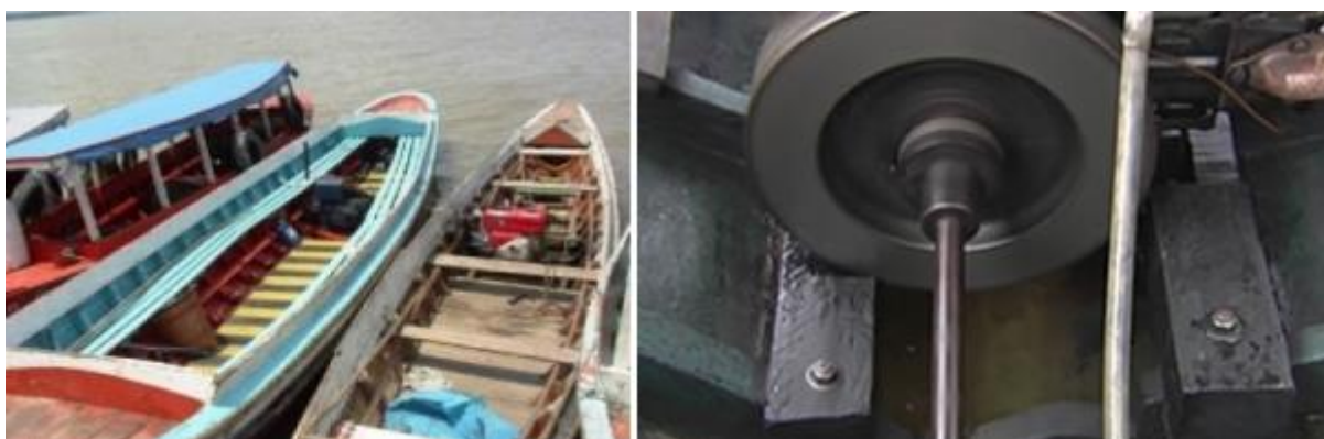
Figura 12 – Condição Perigosa: Eixo exposto na embarcação
