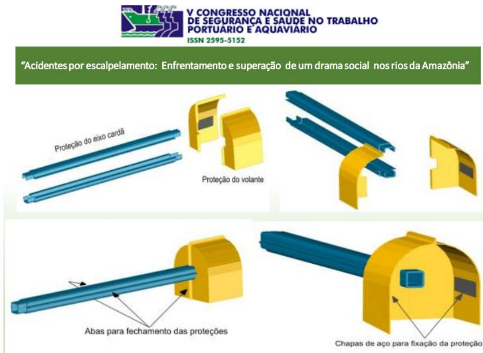
Figura 29 – Estrutura da proteção do eixo desenvolvida em fibra de vidro
